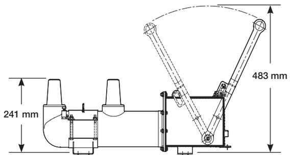
Disponible con boquillas tipo perno de una pieza de 600 A o con boquillas tipo pozo de 200 A, en una o en las dos terminales.
