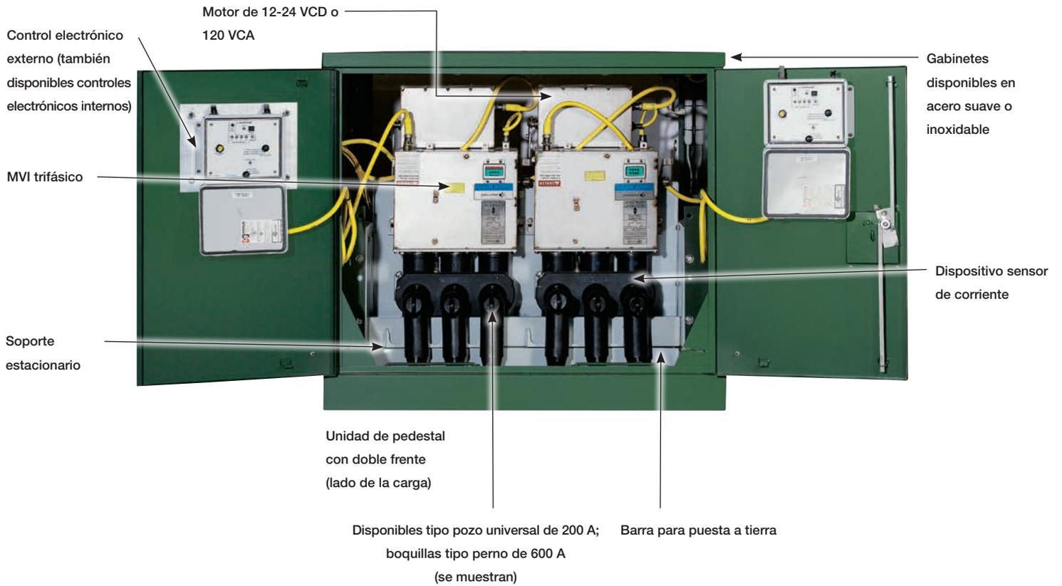
Se proporcionan instalaciones para montaje en pedestal de multivías en gabinetes de acero suave pintadas; de uno o dos frentes.
