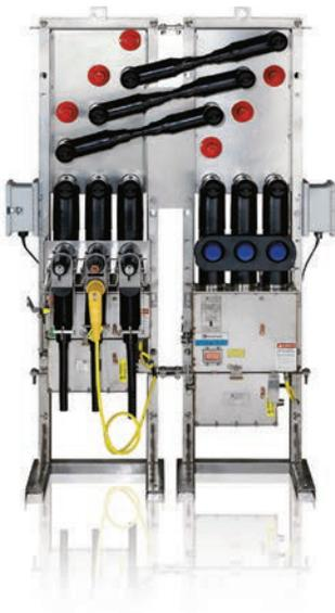
Las unidades sumergibles multivías se fabrican utilizando módulos MVS y MVI de hasta 38 kV, según lo requiera la aplicación. Estos se montan en un sistema moldeado de barras de distribución común y se ensamblan en un marco de montaje independiente, empotrado o de piso.
