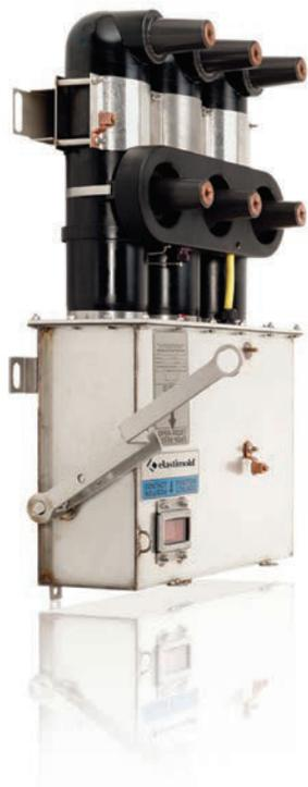
Conducen e interrumpen corrientes de manera automática a través de 25,000 A simétrica en sistemas de distribución de 5 a 38 kV.
