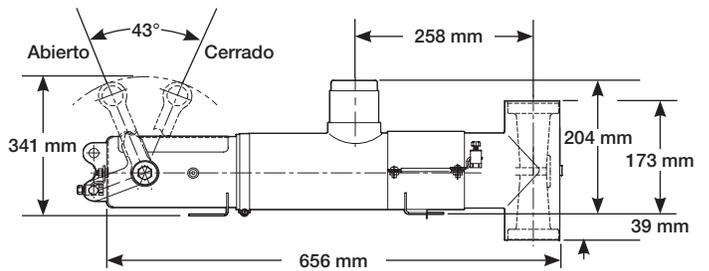
(4) Orificios para montaje, 16 mm de diámetro x 22 mm
