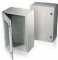
Gabinete para montaje en pared fabricados con lámina de acero de 1.5 mm de espesor, pegada y soldada en proceso automático mediante robot, color RAL 7035. Incluye platina de montaje en chapa de acero galvanizada de 2 mm de espesor y con tapas pasacables superior e inferior en toda la gama.
