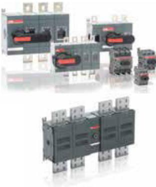
Para ser instalados en el interior de gabinetes o tableros. Cuentan con doble cámara de arqueo, lo que los hace más eficaces en la interrupción del servicio y seccionamiento, además de dejar el fusible totalmente aislado en posición OFF.
