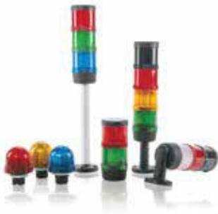
El sistema de torretas de señalización modular de 70 mm, cuenta con una amplia oferta de elementos luminosos y acústicos para todas las tensiones comunes. Un mecanismo de bayoneta permite conectar, tanto eléctrica, como mecánicamente los componentes. Se pueden combinar hasta 5 elementos de señalización por estación.
